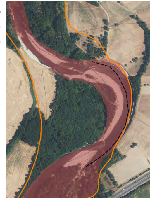
Érosion de berge sur la Garonne à Montsaunès (recul de berge d'en moyenne 30 m lors de la crue de janvier 2022)
